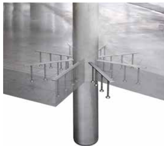
Hvězdicové uspořádání smykové výztuže kolem sloupu.
